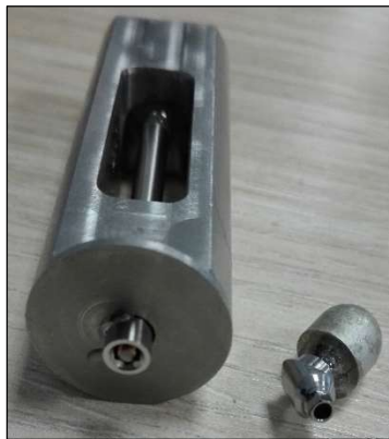
Fig.7 Foto del provino rotto. Frattura della vite per il provino 7 avvenuta a 104980 cicli con carico 300N.
