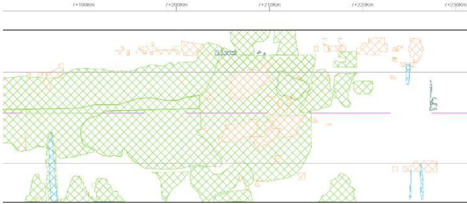
Figura 4-10: Mappatura dei difetti esportata in ambiente CAD (Foria, 2022).
