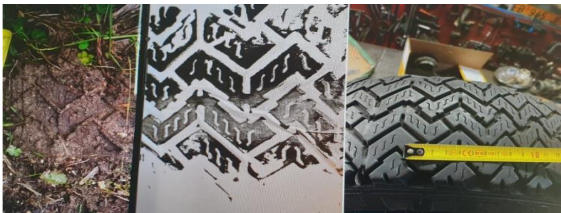
Fotogramma di un'impronta di pneumatico sul terreno. Successivamente è stato riprodotto il calco su foglio e sono state fatte le comparazioni con ruote compatibili per dimensioni, modello e disegno di fabbrica per capire quale macchina sia passata in quel punto.
